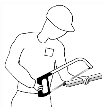
7 - Ajuster le dernier tronçon en sciant l'excédent.
