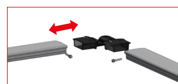
6 - Assembler les mains courantes avec les jonctions et les sous-lisses des tronçons montés. Fixer chaque jonction avec les vis 4,8 x 16 : 2 à chaque jonction de main-courante et 1 entre 2 sous-lisse.
