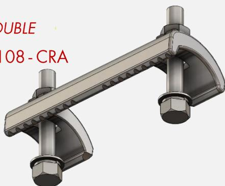
Crapaud double en acier galvanisé, avec 2 vis M12 longueur 80mm. Le crapaud double permet de « pincer » l'aile d'un profil métallique de 3 à 25mm d'épaisseur. La pièce possède un « grip » permettant d'améliorer sa résistance au glissement.
