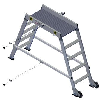
**ETAPE 6**: Positionner les stabilisateurs, puis remonter les pièces de blocage.
